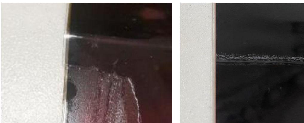
图 4 气泡发生在盖板与偏光片之间（左）、盖板与偏光片发生剥离（右）
